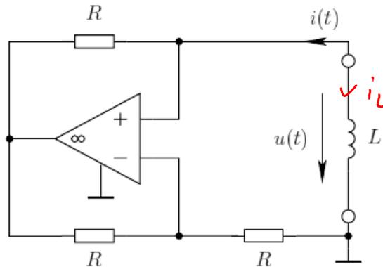
Der resistive Teil der Schaltung ist daher also ein Negativmittanzkonverter mit der folgenden Kennlinie:
